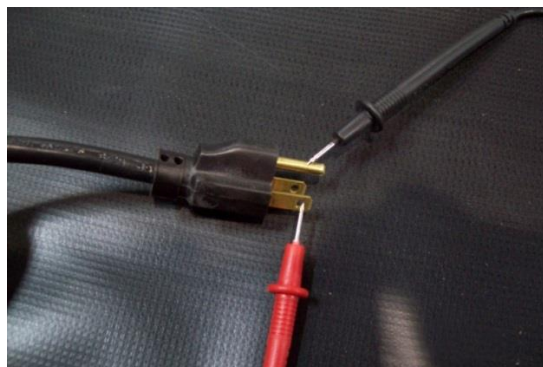
Lame à la mise à terre.
