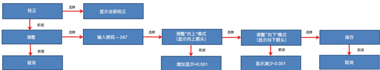
选择**调整**将显示密码的3位数字段。利用前进键，每次输入密码（247）的一位数，将增加一个显示位数。然后，用选择键进入下一位数。按下选择第键进入第三位数后，将出现温度显示器，您可以在其中调整显示的温度。箭头指示器显示您更改温度的方向。按下前进键，数值将以0.001度的幅度增加，直至达到10，然后将以每秒0.01度的速率增加。使用选择键，可分别选择向上调整、向下调整、**保存**校正或**取消**（不保存）。保存调整后，您可以在**零点→ 校正→ “显示当前校正”**菜单中查看正在应用的零点调整。
