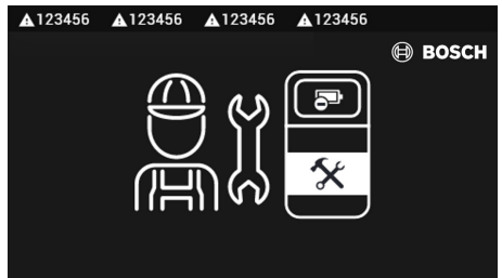
Ill. 21: Écran de demande d'entretien avec codes de défaillance
